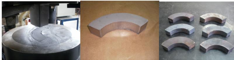
Figura 2 – Compactação; Peça a Verde; Peça Sinterizada respectivamente.
